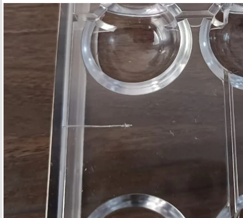
1. Esempio di difetto estetico non conforme
