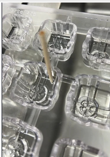
5. Esempio di non conformità alveolo/stampo
