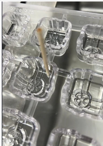
5. Esempio di non conformità alveolo/stampo
