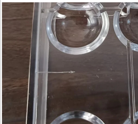
1. Esempio di difetto estetico non conforme
