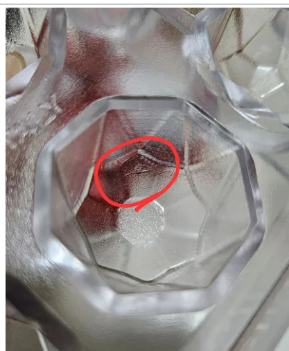
3. Esempio di difetto estetico non conforme
