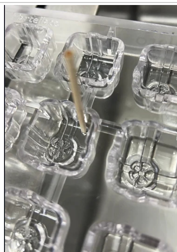
5. Esempio di non conformità alveolo/stampo
