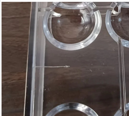
1. Esempio di difetto estetico non conforme
