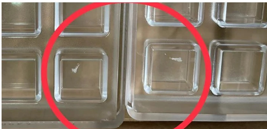
6. Esempio di impurità nell'alveolo non conforme
