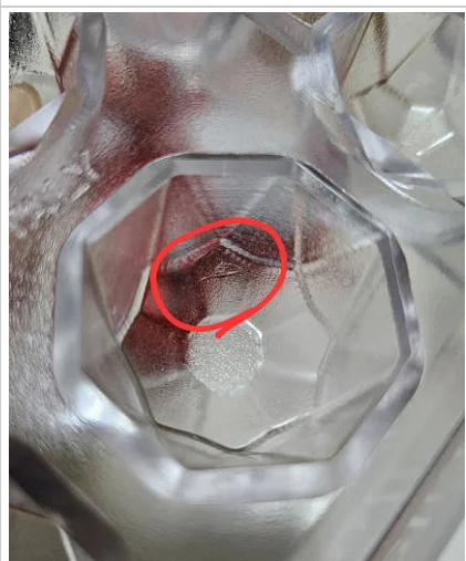
3. Esempio di difetto estetico non conforme
