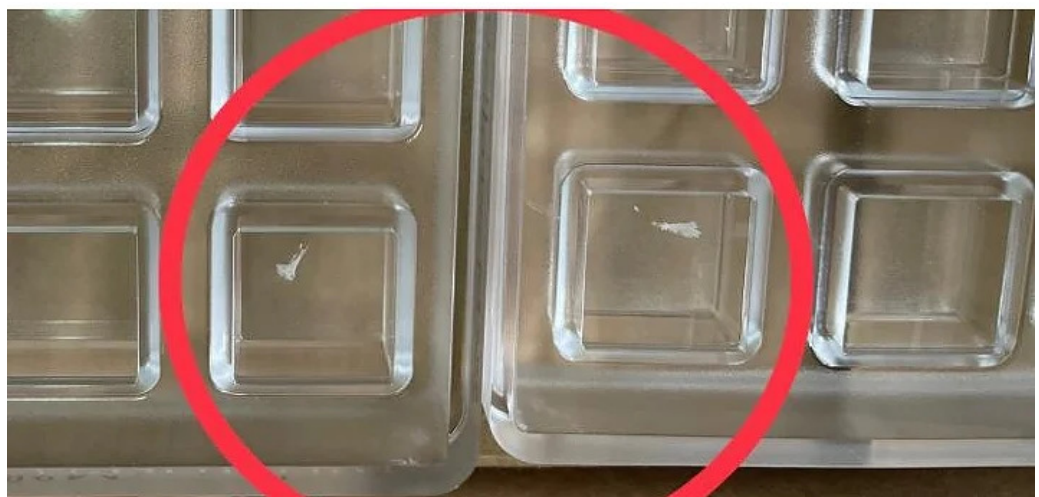
6. Esempio di impurità nell'alveolo non conforme
