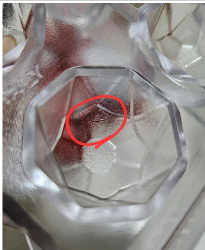
3. Esempio di difetto estetico non conforme
