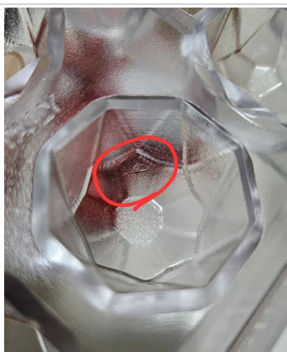
3. Esempio di difetto estetico non conforme
