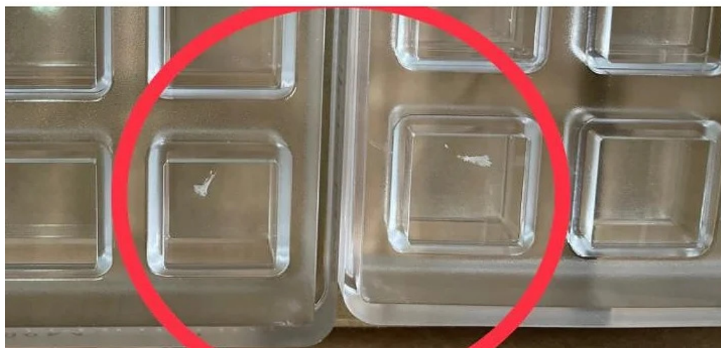
6. Esempio di impurità nell'alveolo non conforme
