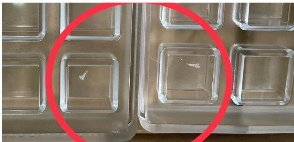
6. Esempio di impurità nell'alveolo non conforme
