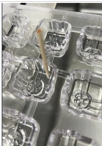
5. Esempio di non conformità alveolo/stampo
