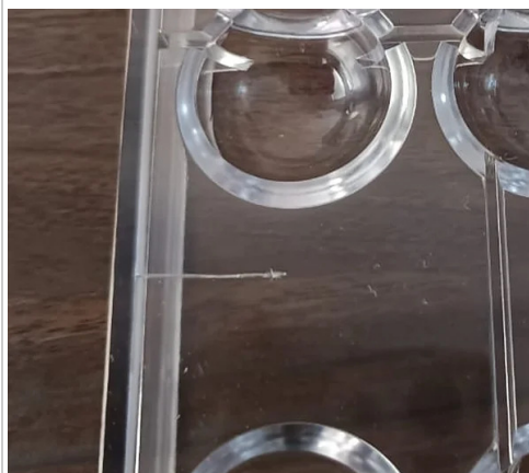
1. Esempio di difetto estetico non conforme
