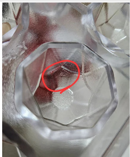
3. Esempio di difetto estetico non conforme
