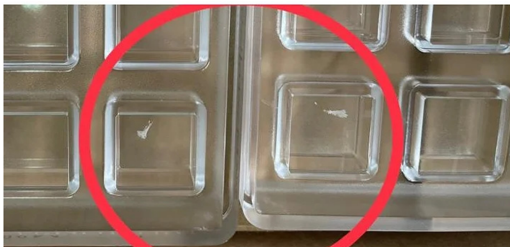
6. Esempio di impurità nell'alveolo non conforme
