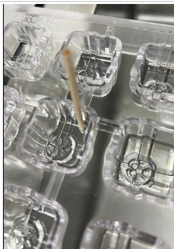
5. Esempio di non conformità alveolo/stampo
