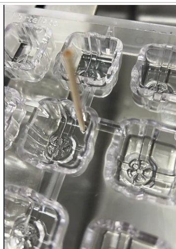
5. Esempio di non conformità alveolo/stampo
