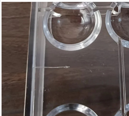
1. Esempio di difetto estetico non conforme
