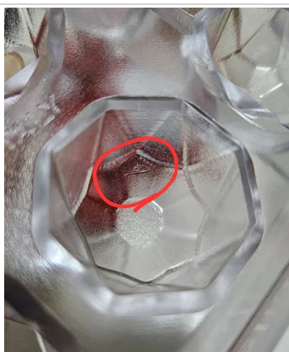
3. Esempio di difetto estetico non conforme
