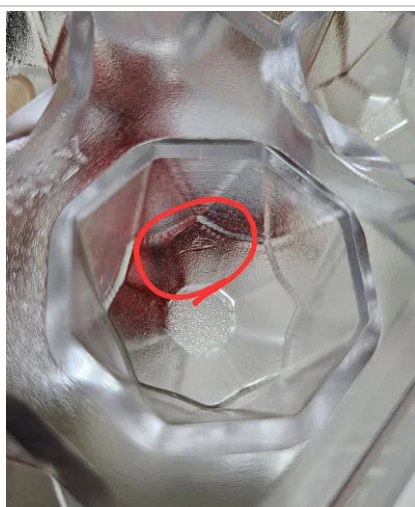
3. Esempio di difetto estetico non conforme
