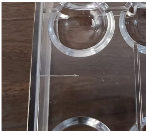
1. Esempio di difetto estetico non conforme
