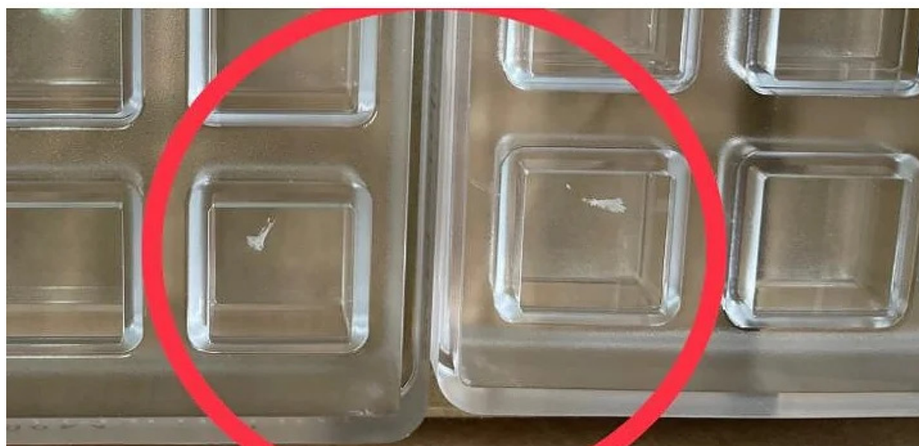
6. Esempio di impurità nell'alveolo non conforme
