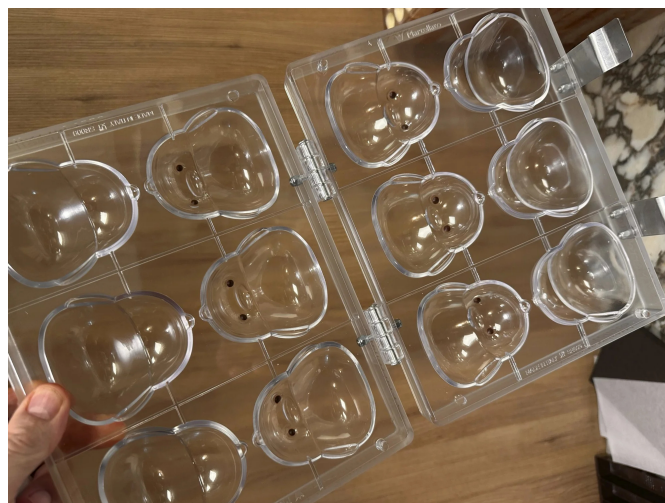
4. Verificare il corretto senso di accoppiamento dei due stampi.
