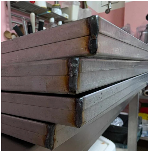
1.difetto saldatura non accettabile welding defect not acceptable
