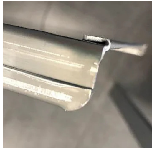
2.difetto bordi taglienti non accettabile Sharp edge defect not acceptable
