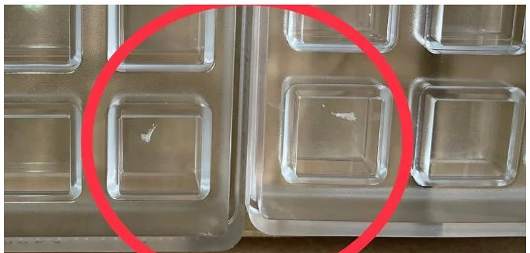
6. Esempio di impurità nell'alveolo non conforme
