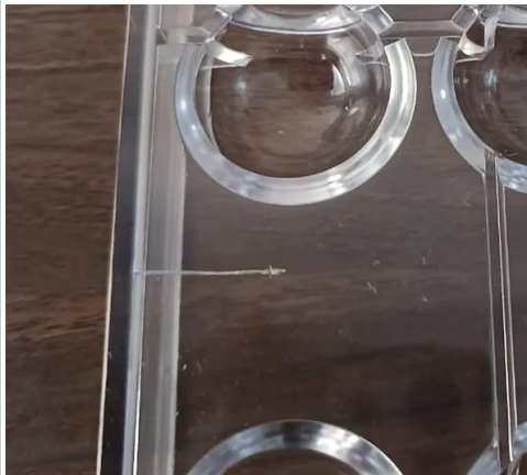
1. Esempio di difetto estetico non conforme
