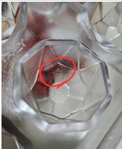
3. Esempio di difetto estetico non conforme
