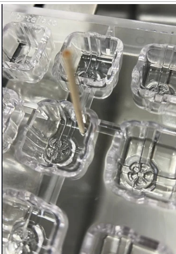
5. Esempio di non conformità alveolo/stampo
