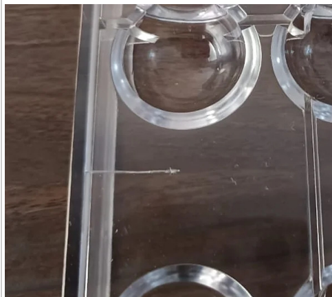
1. Esempio di difetto estetico non conforme
