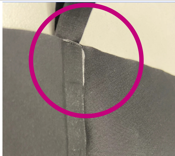
2.Esempio di sbavatura non conforme
