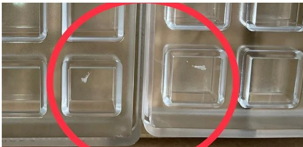
6. Esempio di impurità nell'alveolo non conforme
