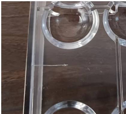
1. Esempio di difetto estetico non conforme
