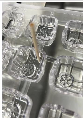
5. Esempio di non conformità alveolo/stampo
