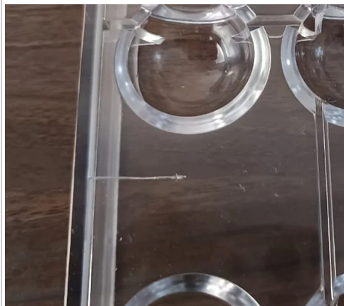
1. Esempio di difetto estetico non conforme
