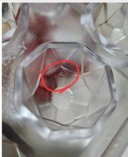
3. Esempio di difetto estetico non conforme
