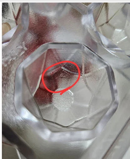
3. Esempio di difetto estetico non conforme
