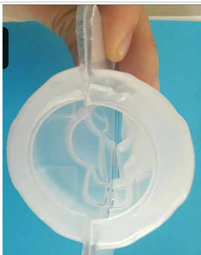
1. Accoppiamento perno/foro sfalsato.
