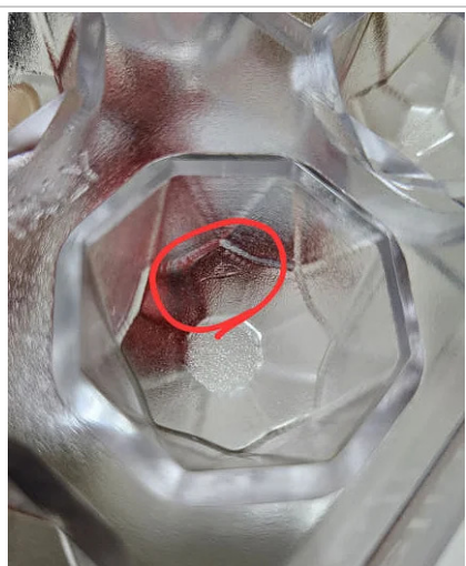
3. Esempio di difetto estetico non conforme
