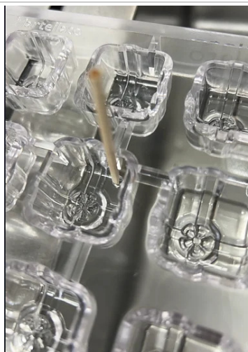
5. Esempio di non conformità alveolo/stampo
