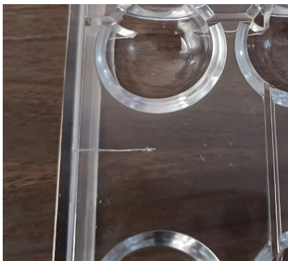
1. Esempio di difetto estetico non conforme
