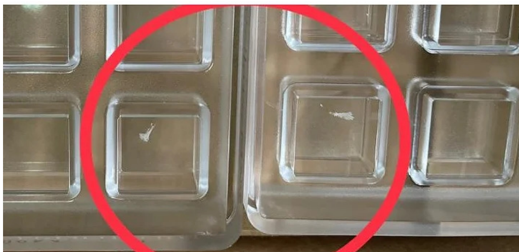
6. Esempio di impurità nell'alveolo non conforme
